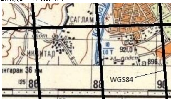
Рис. Будущий фрагмент карты СК42 с нанесением координатной сетки WGS84.
