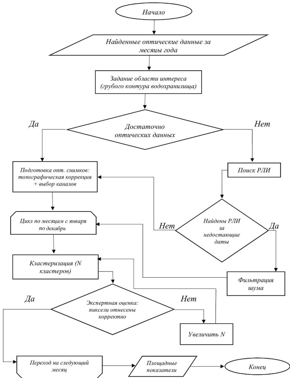
Рис. 2. Процедура обработки данных при оценке площади водохранилищ
