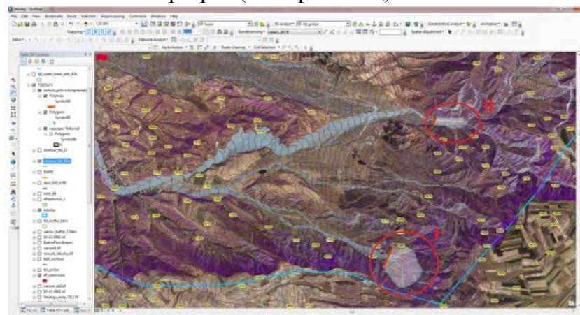
Рис. 3. Карта-схема определения местоположения плотин. I-грунтовая плотина с селеханилещем; II-применение гибких конструкций для каскада и уменьшения разрушительных воздействий селевого потока.
